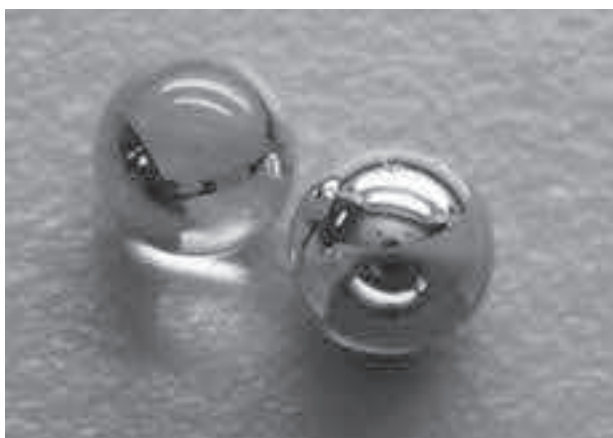
直径3mmのボールSAW
