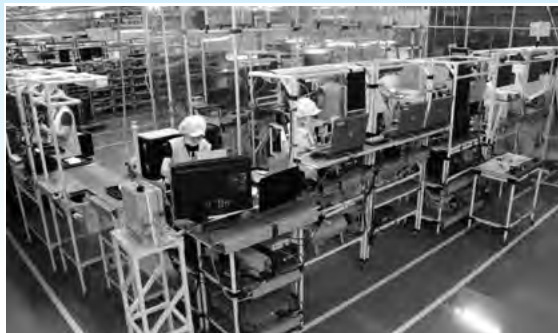
セル生産方式による作業風景
